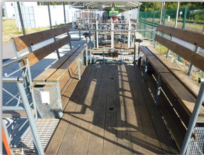
Clubdraisine mit 4er Fahrrad Antrieb, Variante ohne Tisch
